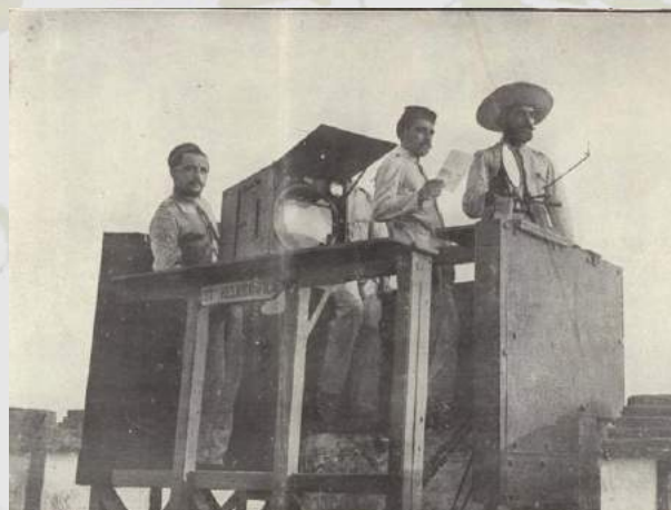
Estación heliográfica de campaña, usando una linterna Mangin
